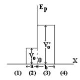
6- Dada la función potencial mostrada en la figura y suponiendo que la partícula procede desde el lado negativo del eje X, escriba la función de onda en cada una de las regiones para el caso en que  $\ E > V_0$
