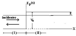
5.- Considerando las funciones de potencial mostradas en la figura, escriba las funciones de onda en cada una de las regiones del eje X, suponiendo que la partícula incide desde el lado positivo del eje X, para el caso en que  $V_0 < E < V_0$ .
