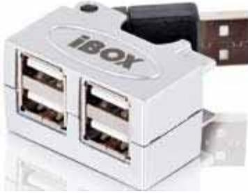
La mayoría de las computadoras suelen tener entre 2 y 8 puertos USB, por lo que puede necesitar un *hub* (conector múltiple) para conectar más de dos unidades periféricas. El hub regenera las señales y normalmente proporciona entre 4 y 7 conexiones.
