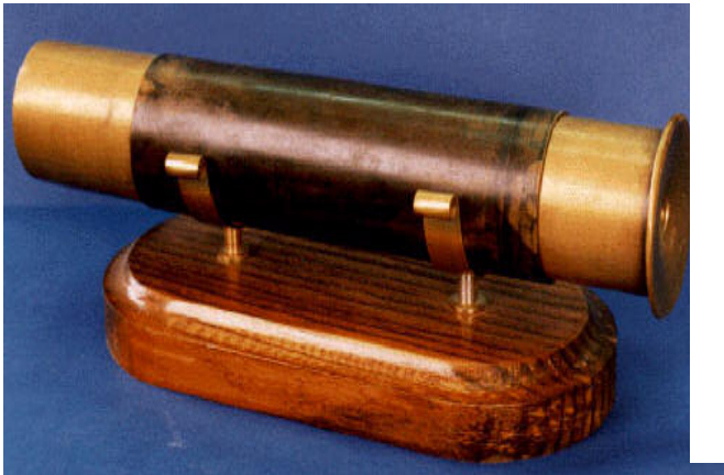
Figura 3: A la izquierda: Microscopio compuesto realizado por los hermanos Juan y Zacharias Janssen en 1590, en Midelburg, Holanda. Está formado por dos tubos de latón, soportando una lente cada uno, que se deslizan dentro de otro tubo de latón lo que permite el enfoque. Se considera el primer microscopio compuesto de la historia. A la derecha: Microscopio compuesto de Galileo Galilei, 1612. Posee dos lentes instaladas en dos cilindros de madera que se deslizan sobre uno exterior de cartón, forrado de cuero verde, permitiendo el enfoque. El acabado, con tapadera incluida, es de un marcado carácter renacentista italiano.
